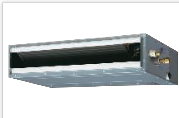
Iglotech, Klimatyzatory zwarte kanałowe RDG...LLTB. Cechy szczególne: kompaktowa konstrukcja z wbudowaną pompką skroplin, rozszerzony zakres ciśnienia dyspozycyjnego oraz możliwość zabudowy w pionie i poziomie. Wydajność: chłodzenie (3,5 do 5,2 kW), grzanie (4,1 do 6,0 kW).
